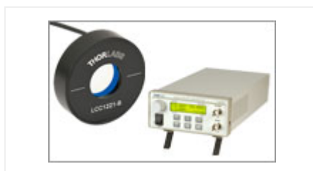
ЖК фазовые пластинки, макс. сдвиг: 3/4\lambda
